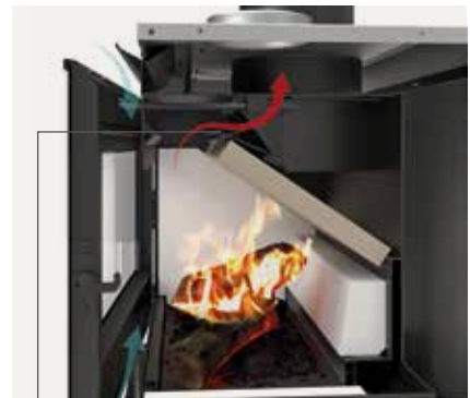
3- BEI OFFENER TÜR. Die Bypass- Rauchgasklappe ist vollständig geöffnet und die Rauchgase ziehen rasch zum Rauchrohr hin ab.
